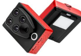
Figure 12 : Caméra Parrot Sequoia avec à gauche la face inférieure et les 4 canaux (vert, rouge, Red Edge, NIR) et à droite la face supérieure et le capteur de lumière incidente. (Source : [https://www.parrot.com/jp/sites/default/files/sequoia\\_official\\_documentation\\_and\\_specifications\\_2016\\_0.pdf](https://www.parrot.com/jp/sites/default/files/sequoia_official_documentation_and_specifications_2016_0.pdf), consulté le 10 août 2018)
