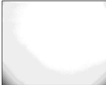
**Figure 18 : Exemple de vignettage avec une image acquise d'une surface blanche. Les zones éloignées du centre sont assombries.**
