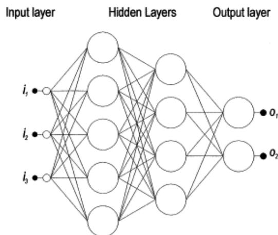
**Figure 24 : Représentation schématique d'un réseau de neurones avec une couche d'entrée, deux couches cachées une couche de sortie. (Source : Gardner M.W. & Dorling S.R., 1998. Artificial neural networks (the multilayer perceptron) - A review of applications in the atmospheric sciences 32(14), 2627–2636.)**
