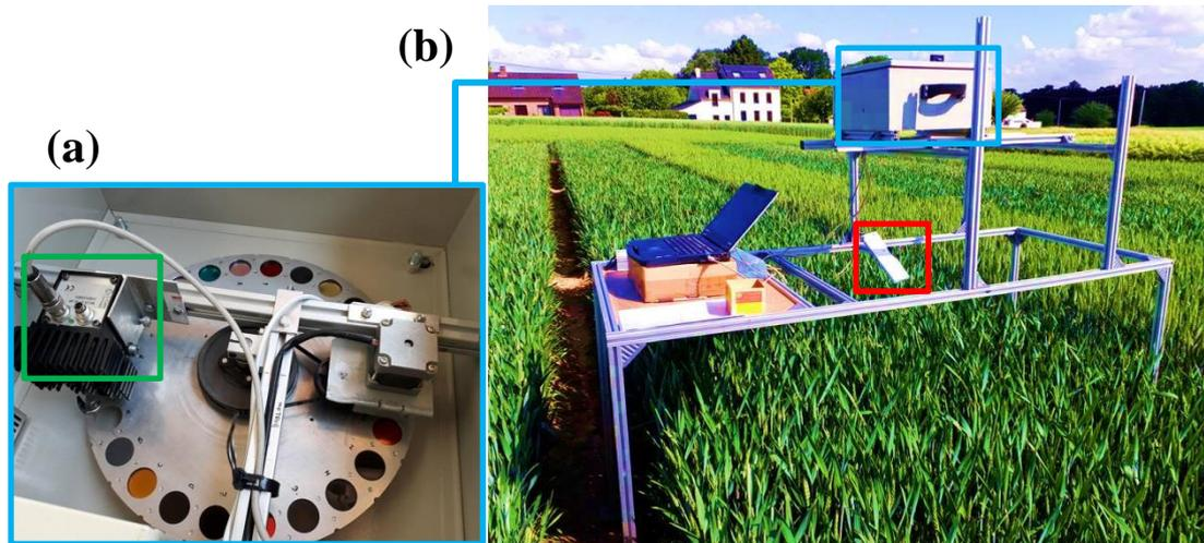
**Figure 14 : Dispositif d'acquisition d'images. A gauche, (a) le caisson dans lequel se trouve la caméra (rectangle vert) et la roue à filtres. A droite, (b) le dispositif complet composé du caisson (rectangle bleu), de la référence blanche (rectangle rouge), de l'ordinateur, de la batterie, et du portique placé au-dessus d'une micro-parcelle.**
