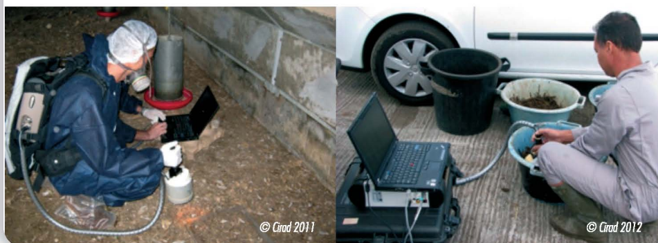
■ Figure 3 – Acquisition de spectres PIR dans les bâtiments (surface des litières ; résultats non présentés dans cette étude) ou après homogénéisation manuelle (exemple de droite illustré pour des fumiers de bovin, plus hétérogènes que les litières).
