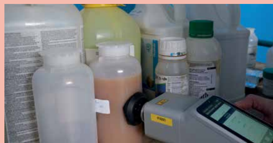
Mesure d'une formulation de pesticide par appareil Raman portable
