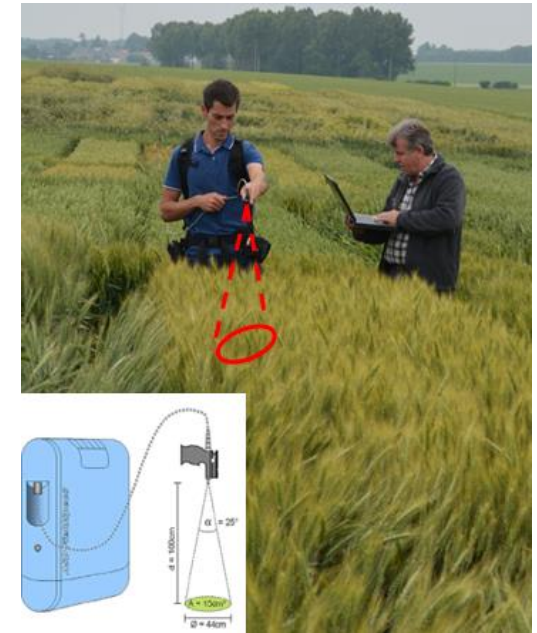
Acquisition de données spectrales avec l'ASD FieldSpec 4
